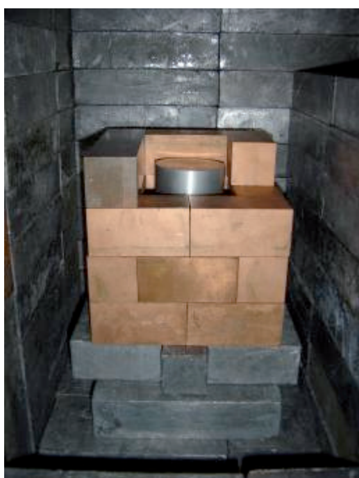
Installation de mesures de radioactivité gamma.
