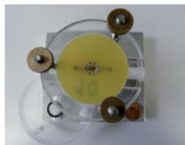
Montage microbalance 50 MHz complet : cellule à circulation, oscillateur thermostaté et pompe péristaltique
