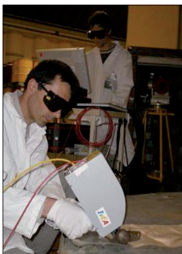
Système LIBS (Laser Induced Breakdown Spectroscopy) à fibres optiques pour l'analyse des éléments, commercialisé par la Start-up IVEA du CEA
